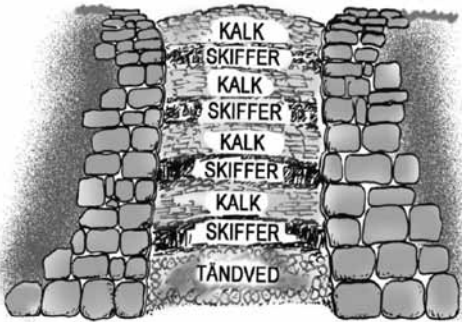
Figur 3. Genomsnitt av kallmurad kalkugn. Länsstyrelsen i Jämtlands län.
