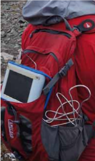
Figur 1. SPARK Data logger i fält: Fotot visar på hur mätutrustningen angjordes med hjälp av ryggsäck. Detta för att förhandsbedömningen gjordes att SPARK Data logger inte skulle kunna hållas i stabilt läge för handli händerna. Bedömningen visade sig stämma, då det delvis handlade om att vi fick hålla i oss med händerna i delar av sluttningen, eller vid passage över is och rinnande vatten.
